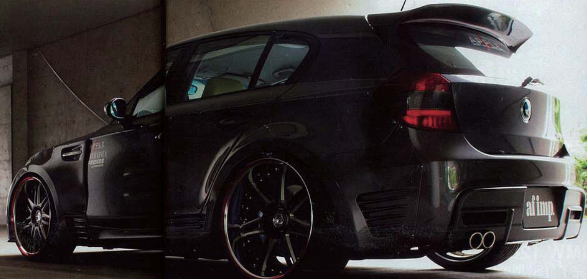
純正パネル入り込み×完全ビス留めという無骨な体裁で魅せるフロントフェンダー。その品質にはアップルのもてる力が遺憾なく発揮される。片側3ピース構造で40ミリの拡張となる
