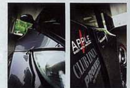
純正パネル入り込み×完全ビス留めという無骨な体裁で魅せるフロントフェンダー。その品質にはアップルのもてる力が遺憾なく発揮される。片側3ピース構造で40ミリの拡張となる
